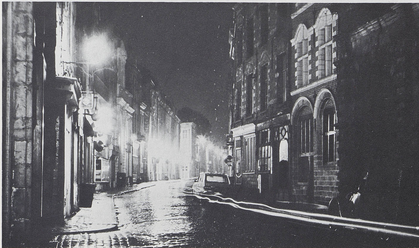
Rue de la Monnaie : pour garder l'esthétique de cette rue, l'éclairage est assuré par des lanternes de style. On essaie, à l'heure actuelle, de doter ce matériel des techniques les plus modernes en y incorporant des sources fluo-ballo pour obtenir un niveau d'éclairage correct sur la chaussée.
