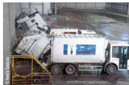
Les camions entrent dans le hall de déchargement et leur contenu va directement dans une fosse.
